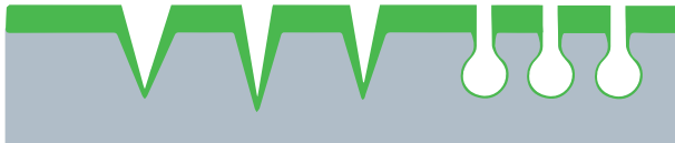
Lo strato non uniforme della nichelatura elettrolitica
